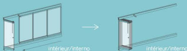
**CONFIGURATIONS DISPONIBLES POUR UN SYSTÈME DE FERMETURE LATÉRALE AVEC POIGNÉE/ CONFIGURACIONES DISPONIBLES PARA SISTEMA DE CIERRE LATERAL CON MANIVELA**
